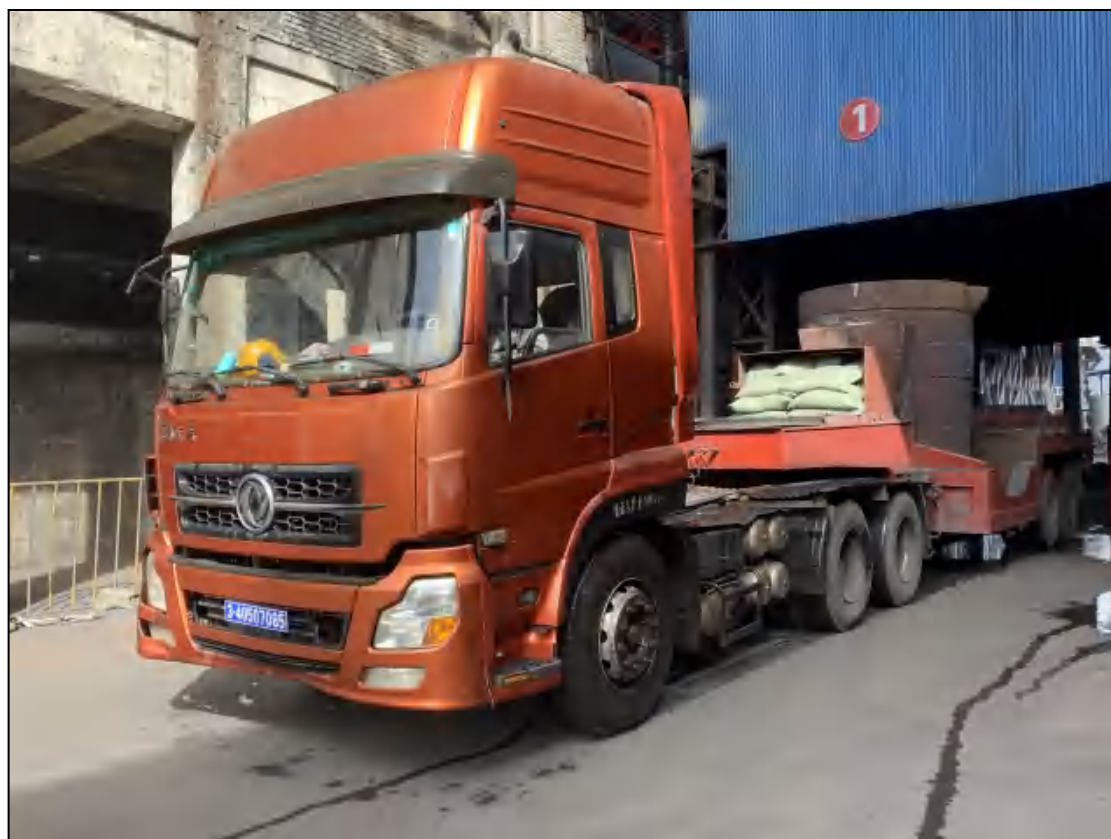
图示：高炉铁水铁水车转运至管厂
